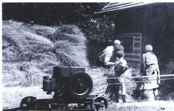
Młocka. Esiok - zwany też motorkim, służył do napędzania młocarni
