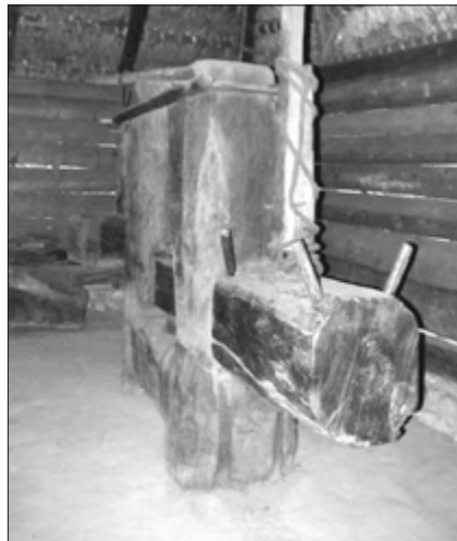
Drewniane urządzenie do wyciskania z ziaren lnu oleju, fot. arch. red.
